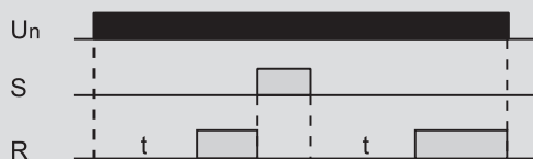
Диаграмма работы реле задержки включения ORT-A
