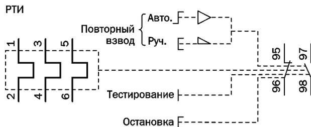
Рис. 1. Схема электротеплового реле
