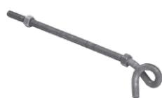
Спиральный абонентский крюк серии КСА позволяет закрепить на нем любой тип зажима (с разделяемой и неразделяемой петлей). Зажим крепится на крюк, «навинчиваясь» на спиралевидный «носик». После крепежа СИП, благодаря натяжению провода, зажим надежно фиксируется на крюке. Спиральный крюк может выдерживать разрушающую нагрузку, эквивалентную 200 килограммам.
