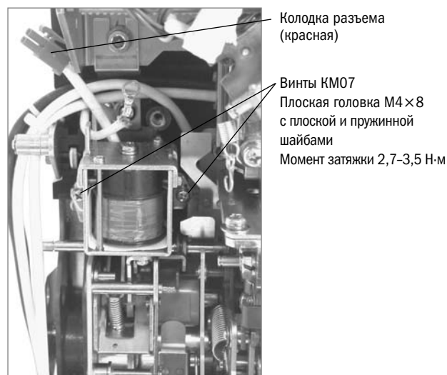
Рисунок 60. Отсоединение КМ07
