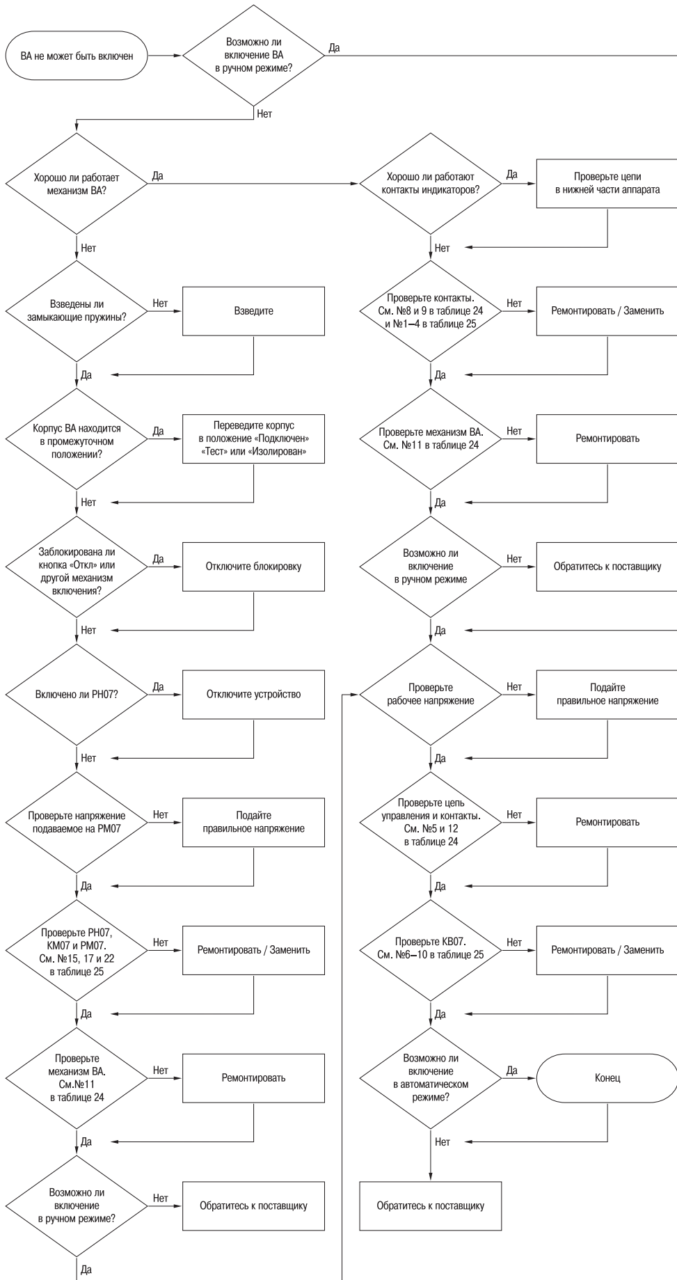
Рисунок 68. Методы устранения неисправности «включение невозможно»
