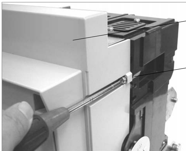
Рисунок 36. Фиксирующие винты панелей
