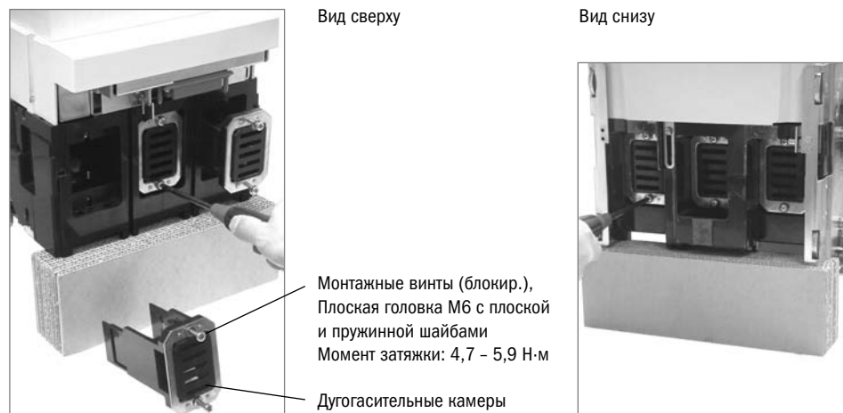
Рисунок 43. Монтажные винты дугогасительной камеры 42
